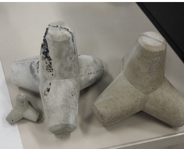
図 2-2 実験素材「テトラポットにホタテ貝の殻を混ぜ、護岸の潮焼けを防げるか」
